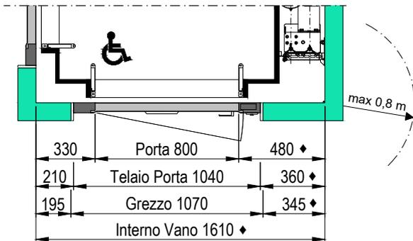
Viene fornito 0,8 m di cavo aggiuntivo per consentire il posizionamento del gruppo di manovra sul pianerottolo nei raggi di 0,8 m dalla posizione standard a cura del Cliente.
